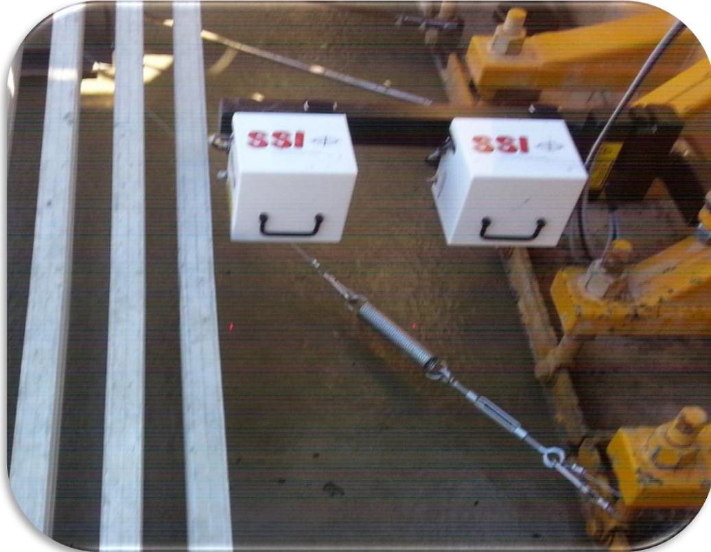
▲ Se Instala en Equipo de Colocación de Pavimento para Medir Superficie en Tiempo Real ▲
